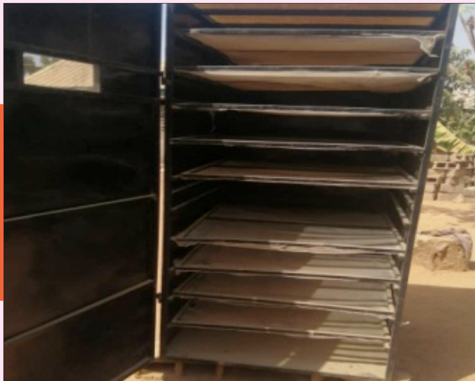
Photo 7 : Séchoir des lamelles d'oignon de la coopérative PADFA Garoua Source d'énergie : solaire / Capacité : 200-250kg/Jr
