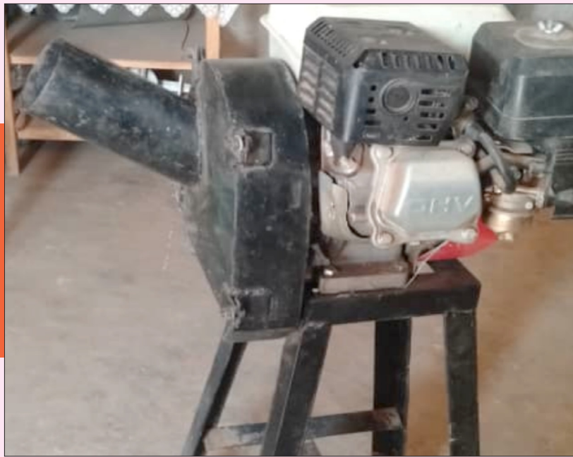
Photo 6 : Hachoir d'oignon mécanique de la coopérative PADFA Garoua Source d'énergie : gasoil / Capacité : 25-30kg/hr
