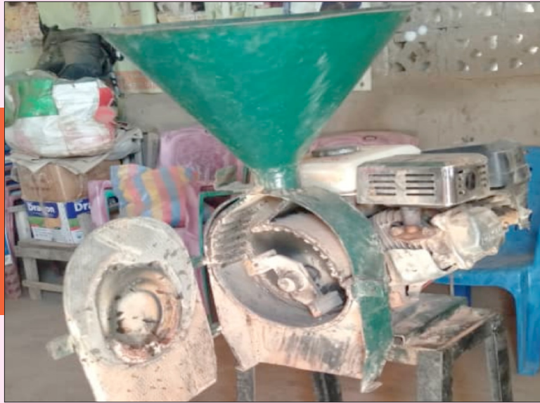
Photo 8 : Broyeur mécanique d'oignon sec de la coopérative PADFA Garoua Source d'énergie : gasoil / Capacité : 15-30kg/hr
